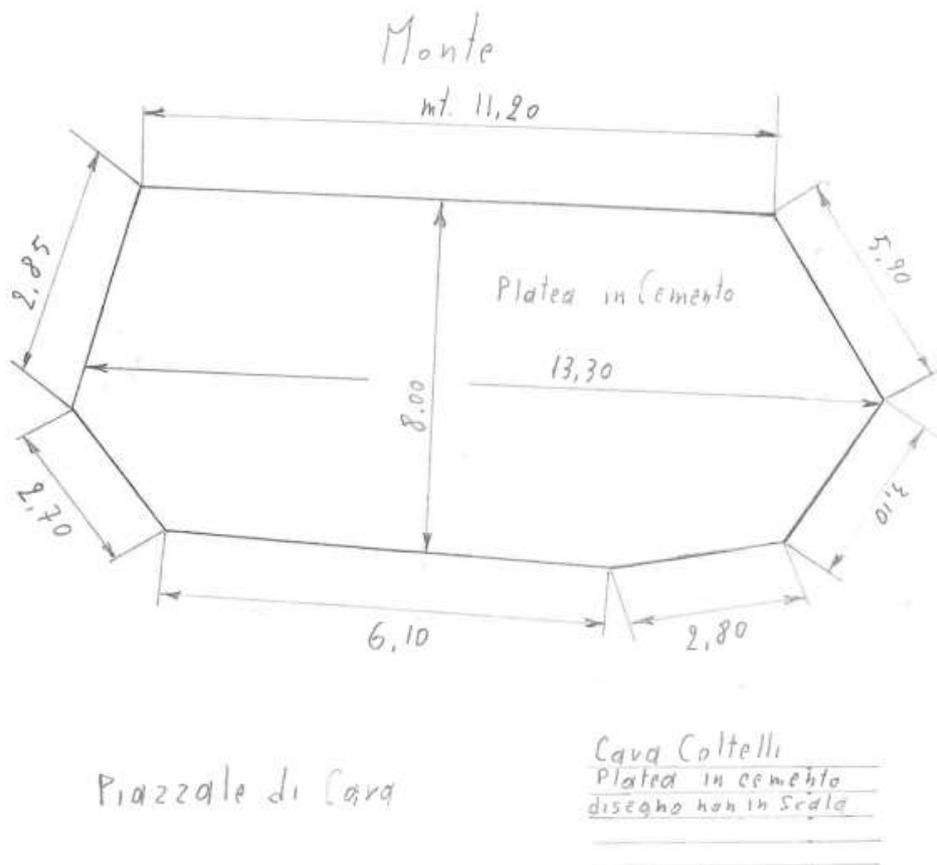
**Foto 2:** Rilievo area servizi in calcestruzzo non strutturale oggetto di rimozione.
