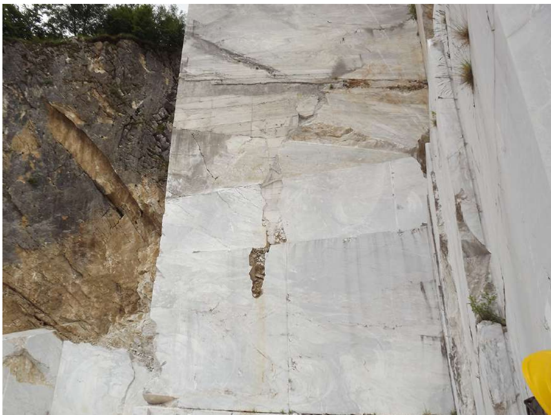
L'ingresso della cavità carsica dopo le opere di tombatura con calcestruzzo
