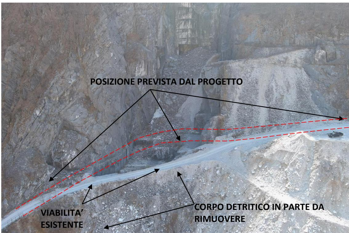
Foto 1. Immagine illustrativa della prevista posizione della viabilità al termine degli interventi previsti per il suo spostamento che prevedono di arretrarla all'interno della vecchia cava così da rimuovere il materiale detritico attualmente antistante la stessa.-
