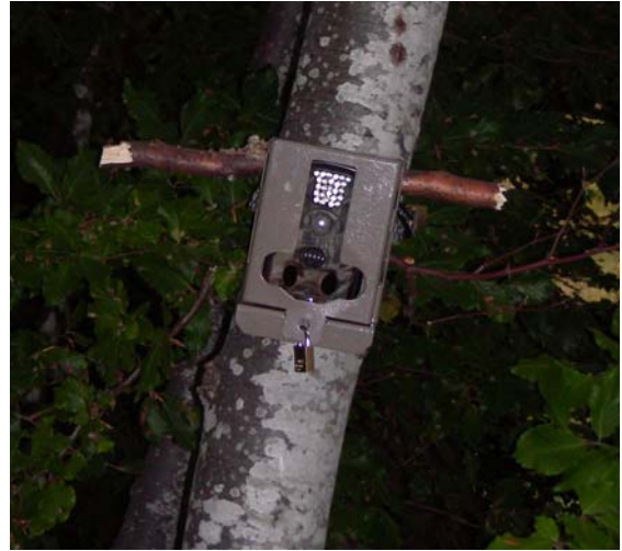
Fig. 4.2.3.1 Foto-video trappole Bolyguard SD 560 (sx) e Multipir-12, munita di protezione in acciaio (dx)
