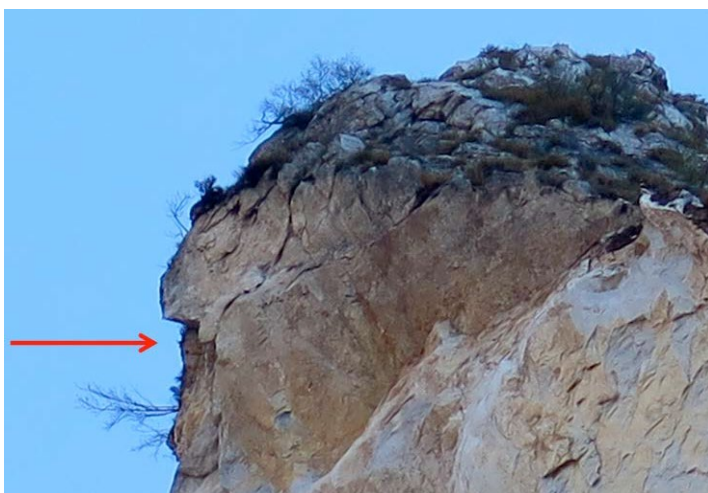
Figure 5 – 6 – Evidenziazione delle fratture esistenti e delle masse instabili
