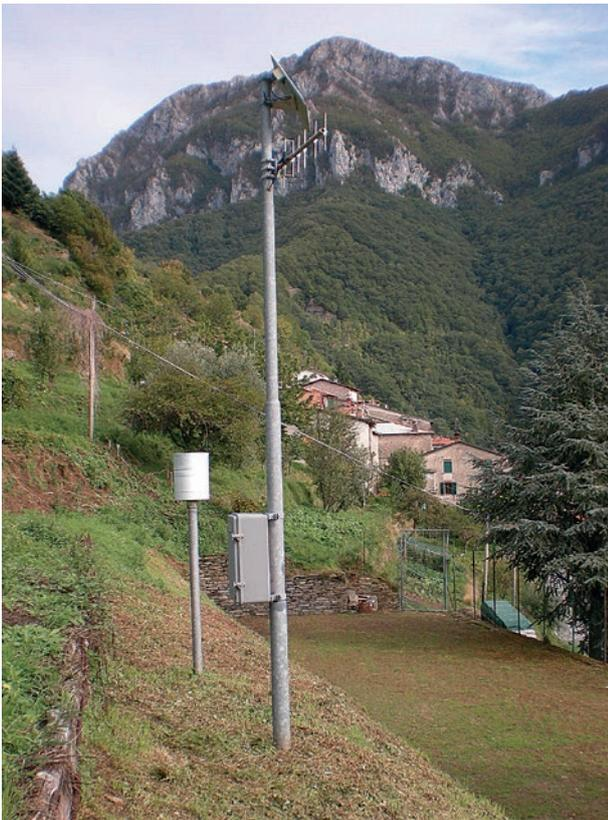
Fig. 14 – Stazione pluviometrica di Pomezzana in Alta Versilia, attrezzata con un pannello solare in tampone con un sistema di batterie per l'alimentazione elettrica del sistema e dell'antenna per la trasmissione dei dati in tempo reale presso l'Ufficio Idrografico e Mareografico dell'Arno di Pisa (foto F. Rapetti)
